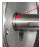
**Kundenspezifische Option für kurze Wellenschultern:** Wenn die Breite der Wellenschulter zwischen 4,76 mm und 9,4 mm beträgt, bieten wir einen kundenspezifischen Ring mit Fasern näher zur Rückseite des Rings. Um diese Option zu bestellen, fügen Sie ein „X“ oder „AX“ der Best.-Nr. hinten hinzu.
