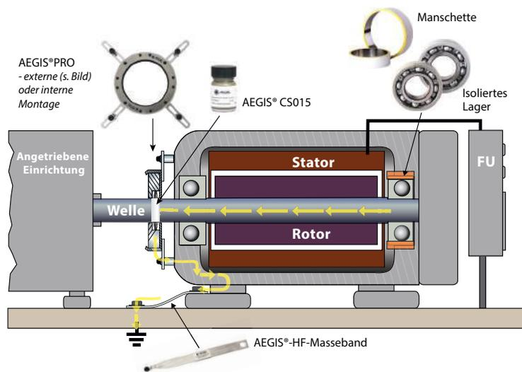
Montieren Sie den AEGIS® Wellenerdungsring auf der entgegengesetzten Seite zur Isolation.
