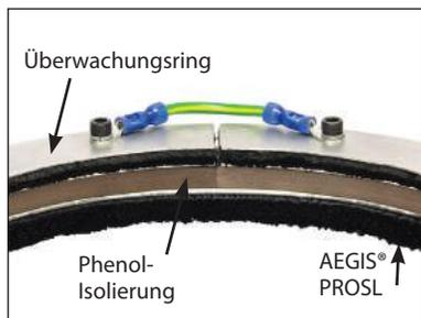
Der AEGIS® PROMR-Überwachungsring kombiniert den AEGIS® PROSL-Ring mit einem isolierten SGR-Ring, der als Überwachungsgerät verwendet werden kann. Der PROSL leitet die Spannungen und Ströme sicher zur Erde, während der SGR-Überwachungsring die Spannung an der Welle misst und nicht geerdet ist. Eine zwischen 2 Ringen montierte Phenol-Platte dient zur Isolierung des Überwachungsringes.
