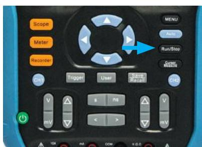
Während der Durchführung von Messungen wird der Bildschirm durch **RUN/STOP** angehalten. Wenn die Anzeige angehalten wurde, wird „STOP“ oben links auf dem Bildschirm angezeigt.
