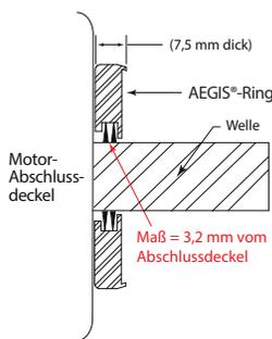
Messen Sie den Wellendurchmesser an einer Stelle, die 3,2 mm vom Motorabschlussdeckel entfernt ist. Beachten Sie dann die Teileliste zur Bestimmung der richtigen Teilenummer und der gewählten Montageoption.
