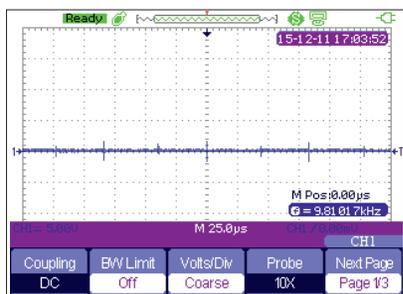
Hier wird das CH1-Menü gezeigt. Durch Drücken auf **MENU** wird es ausgeblendet.
