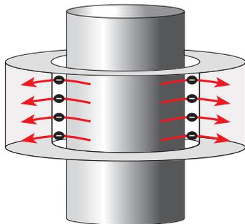
Dieser Mechanismus basiert auf die Fähigkeit von Elektronen, durch den Tunneleffekt Isolationsbarrieren in Luftspalten kleiner 2 nm zu überwinden.
