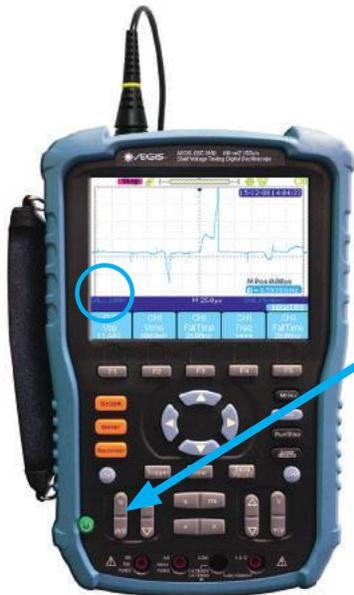
Eine EDM-Entladungskurve zeigt den Anstieg der Spannung und dann eine steile vertikale Linie. Die steile vertikale Linie entsteht in dem Moment der Entladung zur Erde. Um ein gutes Bild von einer Entladung zu erhalten, müssen Sie die Anzeigeskala ggf. anpassen.
