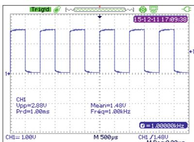
...und direkt der Vss-Wert auf dem Bildschirm angezeigt. Diese Ansicht bleibt bestehen, bis ein Menü aufgerufen wird.
