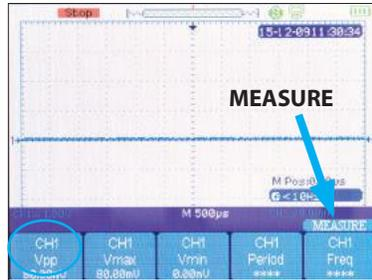
Drücken Sie auf **CURSOR|MEASURE**
