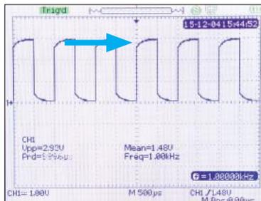
Drücken Sie auf **AUTO**. Auf dem ScopeMeter wird eine Reihe von ungefähr rechteckigen Wellen mit einer Amplitude von 3 V und einer Frequenz von 1 kHz angezeigt.
