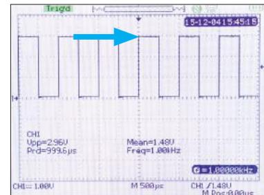
Stellen Sie die Schraube in der Messspitze mit dem mitgelieferten Schraubendreher mit isoliertem Griff so lange ein, bis die Wellen mit geraden Kanten angezeigt werden. Die Messspitze ist nun kalibriert.
