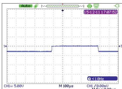
Durch Drücken auf **AUTO** während der Anzeige einer Kurvenform wird die Spannung und die Zeitskalen an die Kurvenform angepasst...
