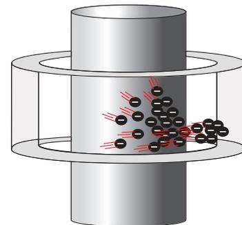
Dieser Prozess resultiert aus dem Kaskadeneffekt von Sekundärelektronen, welche durch Kollisionen freigesetzt werden. Mit der Stoßionisation von Gas-Ionen werden diese in Lücken größer 5 µm beschleunigt. Diese Ionisierung erzeugt negative und positive Ionen, welche die Wellenspannung neutralisieren.
