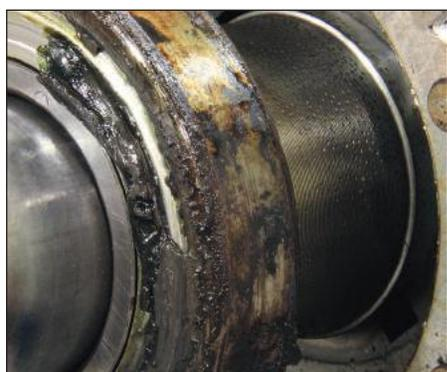
1. **Inspizieren Sie die Außenseiten und das Innere beider Lager** und entnehmen Sie eine Probe des Schmierfetts, wenn weitere Analysen erforderlich sind. Achten Sie auf
