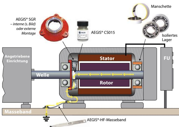
Montieren Sie den AEGIS® Wellenerdungsring am entgegengesetzten Ende zur Isolation.
