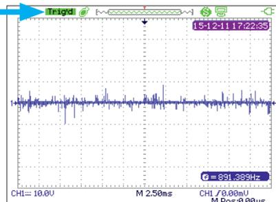
Durch nochmaliges Drücken auf **RUN/STOP** wird die Messung fortgesetzt. Das Wort „Stop“ ändert sich zu „Trig'd“ oder „Auto“.
