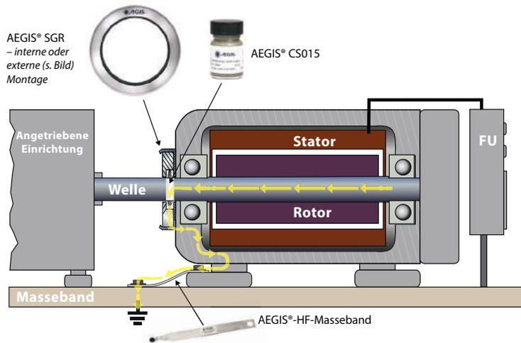
Schützt Motorlager und Lager in angeflanschten Einrichtungen.
