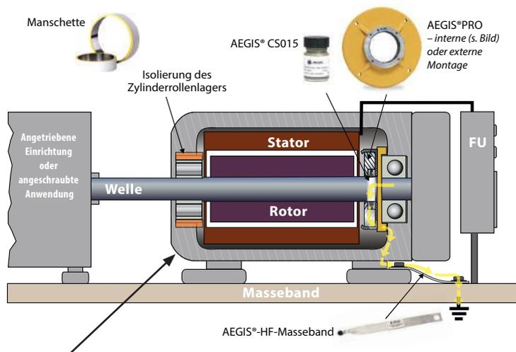
Anmerkung: Bevorzugt wird ein isoliertes Lager auf Antriebsseite. Wenn dies jedoch nicht möglich sein sollte, isolieren Sie stattdessen das Lager auf der Nicht-Antriebsseite und montieren Sie einen AEGIS® Wellenerdungsring auf der Antriebsseite (Seite mit dem Zylinderrollenlager).
