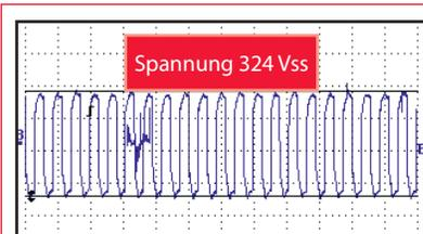
Kapazitive induzierte Wellenspannung vor der Entladung des Lagerstroms durch die Lager. Rechteckwellen vom Stromrichter.
