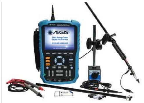
Der AEGIS® Shaft Voltage Tester™-Satz enthält alles, was Sie benötigen, um mit der Prüfung der Motorwellenspannungen zu beginnen. Im Wesentlichen besteht es aus einem 2-Kanal-100-MHz-Digitaloszilloskop mit einem 5,7-Zoll-Bildschirm und einer Funktion zur einfachen Bildschirmaufnahme.
