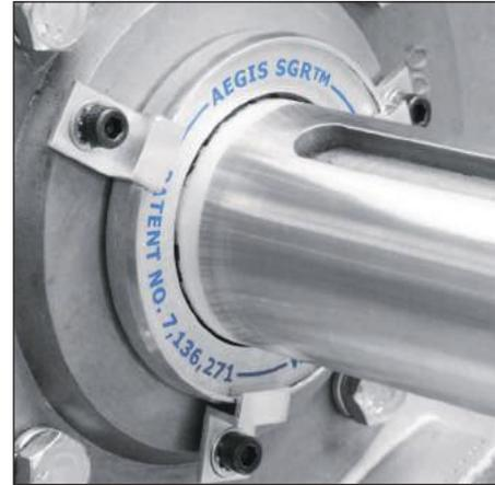
Prüfen Sie nach der Montage mit einem Ohmmeter den Strompfad zur Erde. Berühren Sie mit einer Prüfspitze den Metallrahmen des AEGIS® Wellenerdungsringes und mit der anderen den Motorrahmen.
