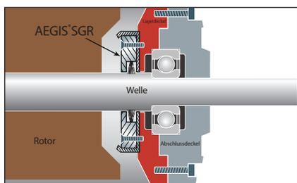
Die interne Montage des AEGIS® Wellenerdungsring im Motor erfolgt in der Regel am inneren Lagerdeckel. Die Befestigung kann mit Durchgangsschrauben oder mit dem leitenden Epoxidharz von AEGIS® erfolgen.
