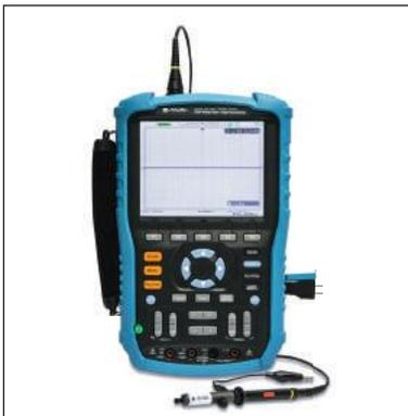
Nun ist das Oszilloskop für die Kalibrierung der Messspitze eingerichtet. Das AEGIS-OSC-9100 ist mit einem Kalibrierungs-Dongle mit zwei Pins ausgestattet, der seitlich am Oszilloskop angeschlossen wird. Dieser Mikro-USB-Dongle generiert zur Feinabstimmung der Messspitze eine Rechteckwelle.
