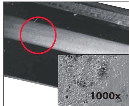
7. **Riffelbildung:** Wird an einem ausgeprägten Waschbrettmuster erkannt. Die Riffelbildung kann mit dem bloßen Auge erkannt werden. Die Riffelbildung wird manchmal mit mechanischen Lagerschäden wie Brinellierung oder falscher Brinellierung verwechselt. Deshalb muss das Muster sorgfältig untersucht werden, um die Riffelbildung den elektrischen oder anderen Ursachen zuzuordnen.
