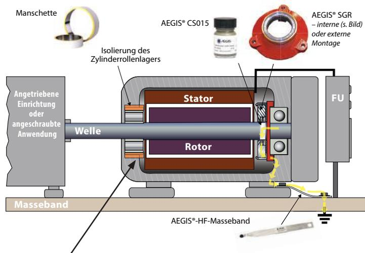
Anmerkung: Bevorzugt wird die Isolierung des Zylinderrollenlagers auf der Antriebsseite. Wenn dies jedoch nicht möglich sein sollte, isolieren Sie stattdessen das Lager auf der Nicht-Antriebsseite und montieren Sie einen AEGIS® Wellenerdungsring auf der Antriebsseite (Seite mit dem Zylinderrollenlager).
