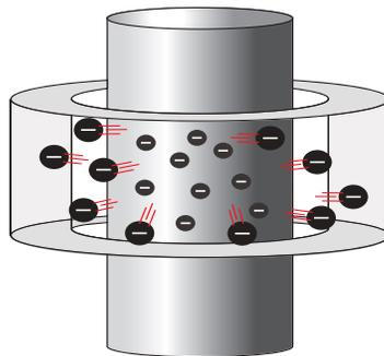
Feldemission ist eine Form des Tunneleffekts, wobei Elektronen bei Vorhandensein eines starken elektrischen Feldes die Barriere überwinden. Dies erzeugt eine zuverlässige Erdung über Abstände von 2 nm bis 5 µm. Das elektrische Feld der Wellenspannungen erzeugt die Bedingungen dafür, dass die AEGIS®-Fasern die Vorteile der Feldemission für die Elektronenübertragung von der Wellen nutzen.
